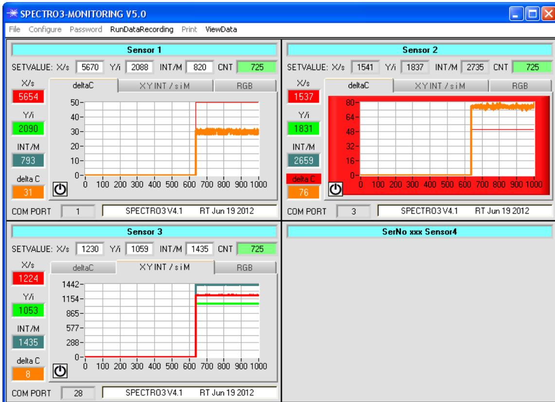
Die im **OUTPUT FILE CONFIGURATION PANEL** ausgewählten Daten werden sofort in der entsprechend angelegten Datei abgespeichert, falls dies aktiviert ist, und auf der Oberfläche visualisiert. Die Gesamtanzahl der aufgezeichneten Werte findet man im Display **CNT**.
