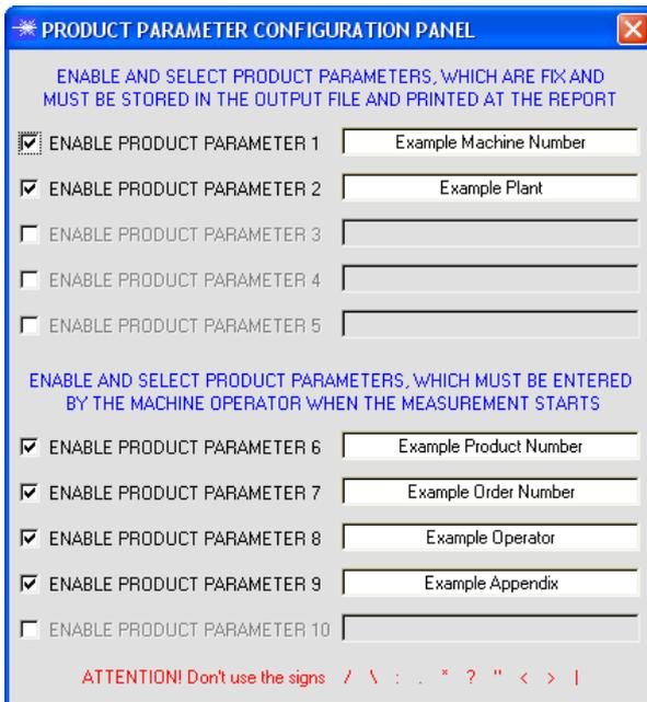
Es stehen 5 Parameter zur Verfügung, die individuell eingegeben werden können. Die Daten sind fix und werden beim Abspeichern, sofern „Enabled“, im File abgelegt bzw. mit ausgedruckt. Die Parameter 6 bis 10 müssen, wenn sie aktiviert sind, vom Bediener nach Drücken von „Start“ eingegeben werden. Die Daten werden ebenfalls im File abgelegt und ausgedruckt.
