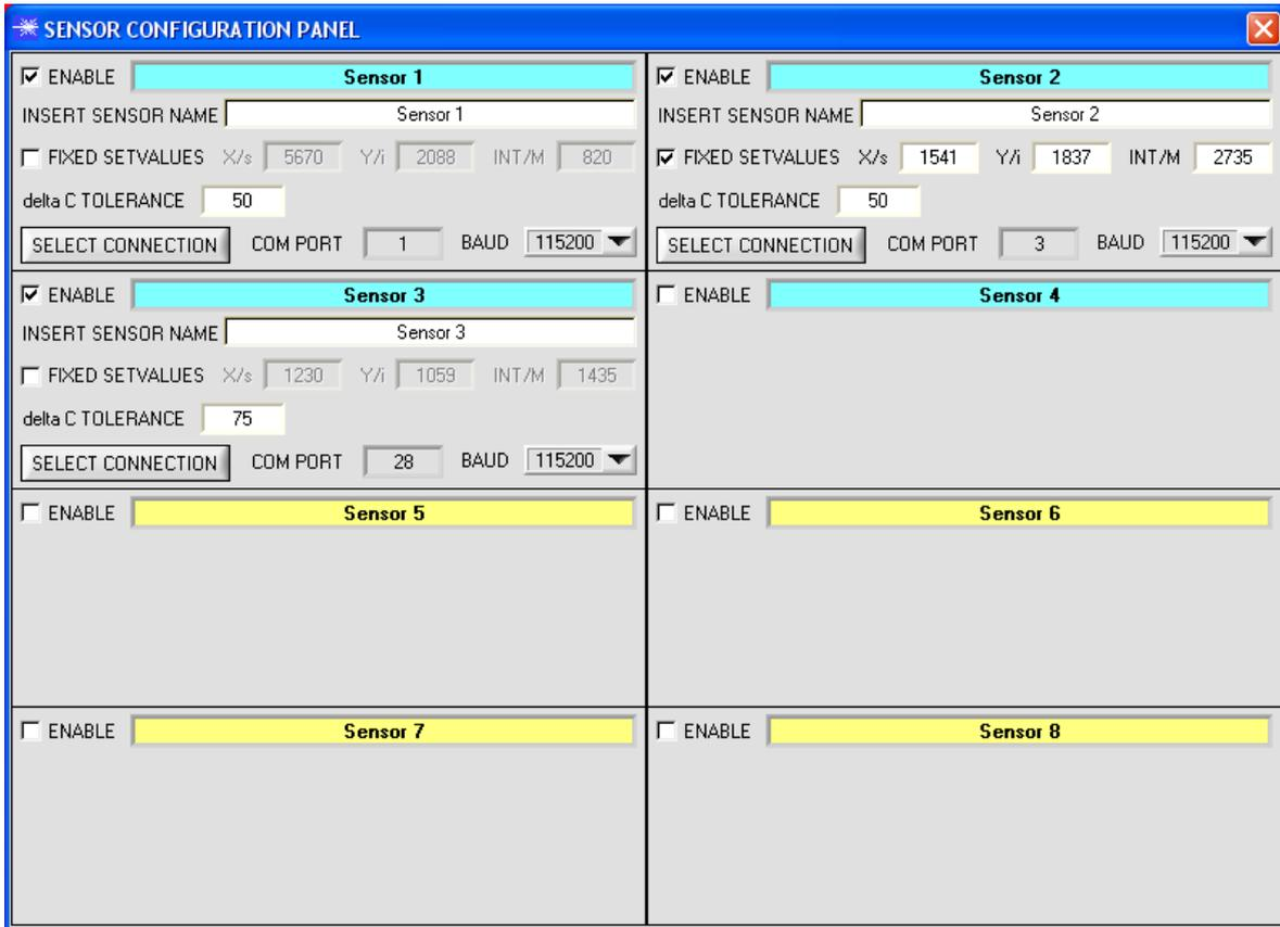
Damit von einem Sensor Daten aufgezeichnet werden können, muss dieser mit „**ENABLE**“ aktiviert werden. Unter „**INSERT SENSOR NAME**“ definiert man einen Namen für den Sensor. Dieser Name wird dann im Hauptfenster angezeigt, im Ausgabefile abgespeichert und ebenso ausgedruckt.
